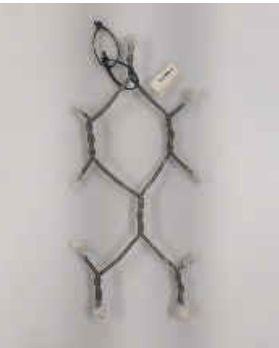
Испытываемый образец до и после воздействия солевого тумана (ISO 9227)
